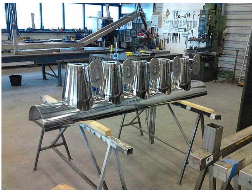
Een hooggepolijste mal voor een waterzuiveringbedrijf.
