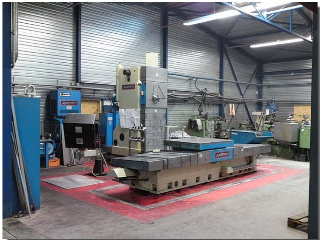
De CNC frees/kottermachine waarop alle gaten in het product worden gemaakt. Ook zie je op de achtergrond nog enkele conventionele draaimachines.
