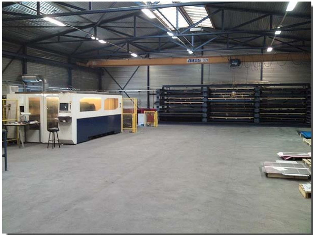
De lasermachine met platenstelling voor alle diktes RVS Plaat. Met de lasermachine worden alle vormen uitgesneden die je maar kan bedenken.
