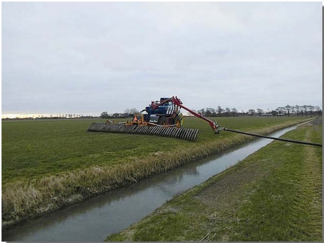
De speciale zwenkarm zorgt er voor dat de slang niet voor de track met de bemester komt te liggen.
